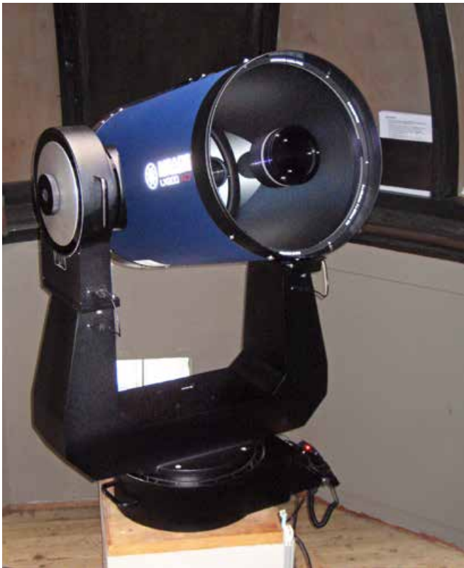
Wieth-Knudsen Observatoriets nye 40 cm kikkert. Udadtil ligner den gamle, bortset fra farven, men optikken er forbedret og giver skarpere gengivelse over et større felt. Foto: Michael Quaade.
